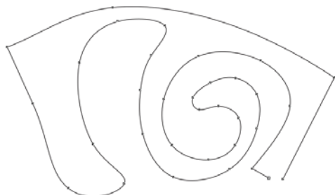
Figure 8 : Objet à tracé ouvert ne pouvant pas accepter de surface. Les deux points nodaux situés dans le coin inférieur droit doivent être joints pour que le tracé soit fermé.
