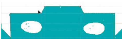
Figure 28 : déplacement des points nodaux pour que la courbe suive le contour de la boîte numérisée
