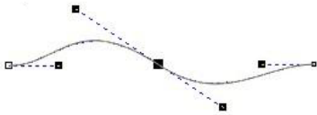
Figure 7 : utilisation de poignées de contrôle pour créer une courbe
